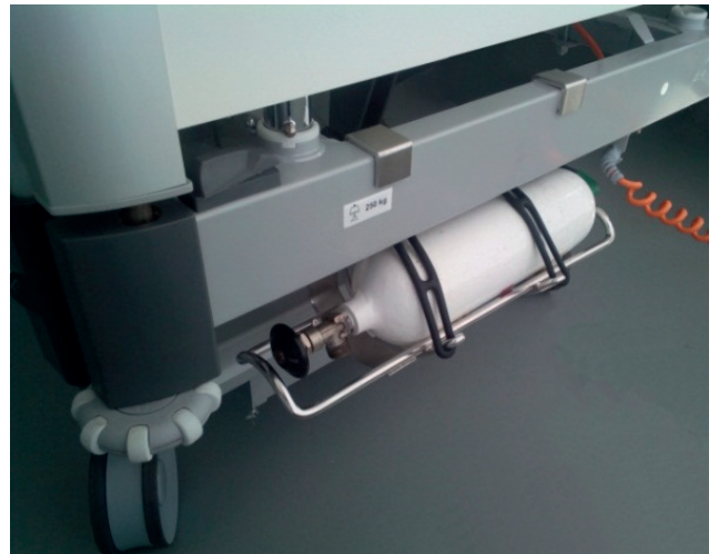
Mynd Lárétt festing fyrir súrefniskút
